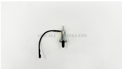
SCHAKELAAR BINNENVERLICHTING OP DEURPOST
